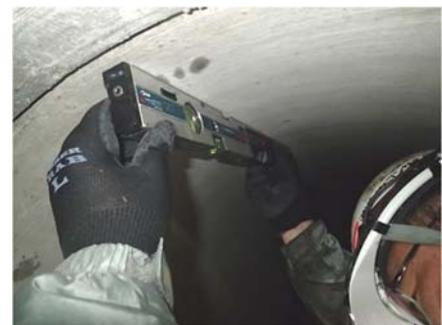
写真-2 管体の傾き測定状況
